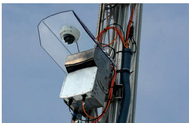
Figura 2: El radar de aludes detecta con fiabilidad las avalanchas con cualquier tiempo y a cualquier hora del día y activa la cámara.
