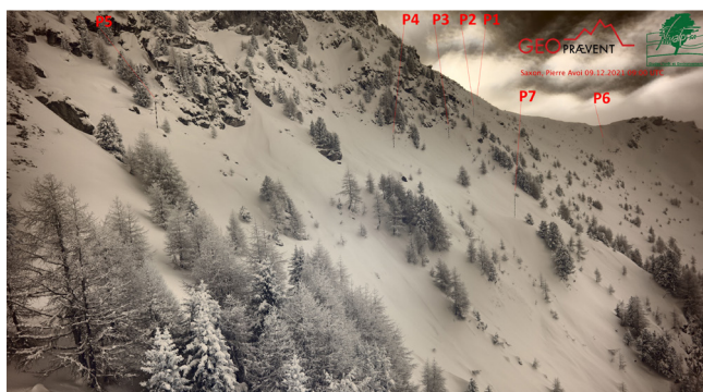
Figure 2 : Image prise par la caméra avec les différentes balises graduées.
