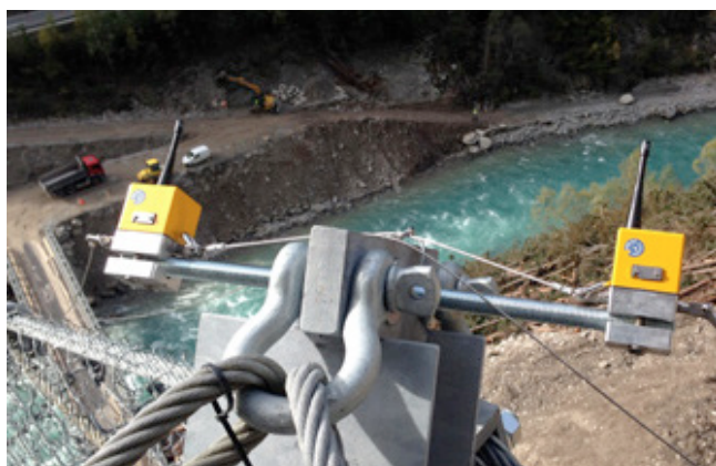
Figure 2 : Les deux points de ruptures à droite et à gauche permettent à chaque capteur de surveiller deux parties d'écrans différentes. Les 1.2 km d'écrans protégeant le chantier de construction sont surveillés avec ces capteurs de mouvement.
