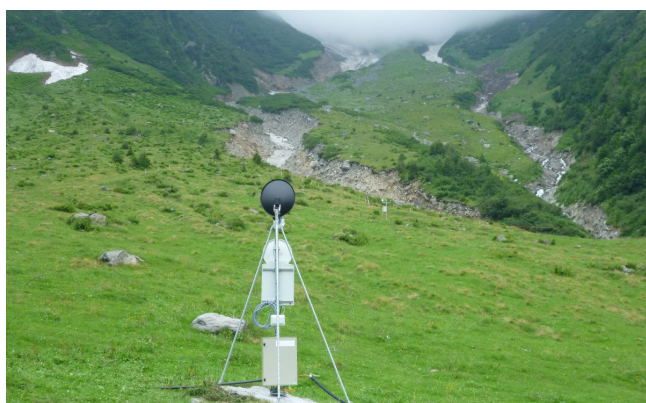
Figure 2 : Un radar Doppler détecte les mouvements dans la partie supérieure de la tranchée.
