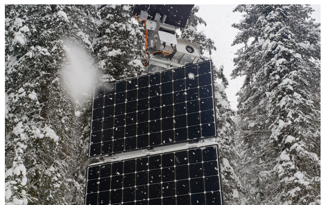
Abbildung 3: Das Lawinenradar detektiert Lawinen in allen Sichtverhältnissen zuverlässig: Tag/Nacht, bei Nebel, Schnee oder Regen.
